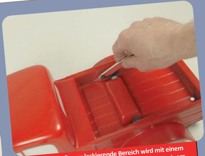
Der von Außen zu lackierende Bereich wird mit einem wasserfesten Stift von außen angezeichnet. Mit einem sehr scharfen Skalpell wird vorsichtig über die markierte Linie ein durchgängiger leichter Schnitt an der Schutzfolie angebracht
