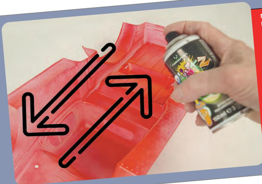
Nach dem Abkleben wird die erste Farbe in drei dünnen Schichten aufgetragen. Die erste Schicht wird nur ganz leicht eingebelt.
