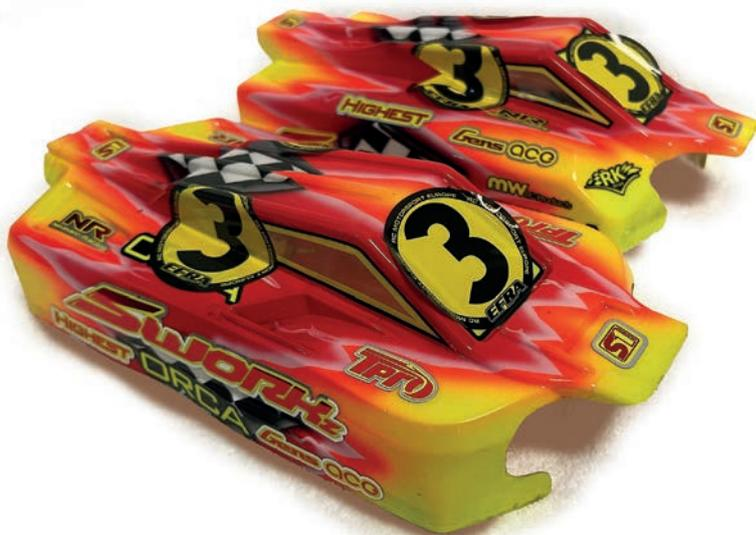
**Zwei verschiedene Karosserieformen: vorne mit Fenster weiter zurück versetzt, hinten mit Fenster weiter vorne für mehr Druck auf der Vorderachse**
