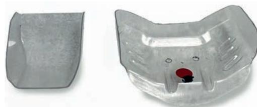
Zwei Frontspoiler zur Montage vor bzw. hinter der Dämpferbrücke
