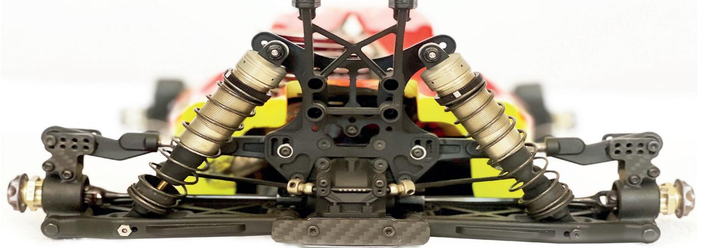
verliert man aber etwas am Kurvenausgang. Das Fahrzeug wird tendenziell mit weniger Nachlauf auch etwas nervöser zu fahren. Mit mehr Nachlauf hat man im Kurvenausgang beim Beschleunigen mehr Lenkung und das Fahrzeug ist gutmütiger zu fahren. Als Tipp kann man sich merken, das auf Strecken mit sehr viel Grip eher mehr Nachlauf gefahren wird und auf wenig Grip weniger, um die meiste Lenkung zu bekommen.
