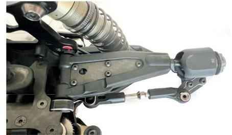
NachlaufEinstellung am obereb Querlenker durch Klipse
