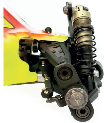
Gut zu erkennen der Nachlauf an dem schräg stehenden Achsschenkel
