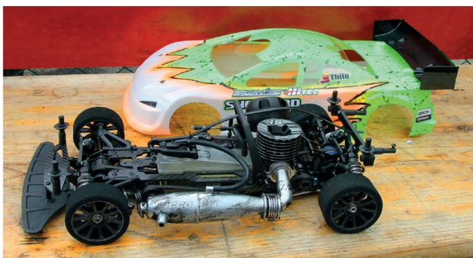
**Karosserie und fahrfertiges Chassis eines typischen Tourenwagens 1:10 Nitro**
