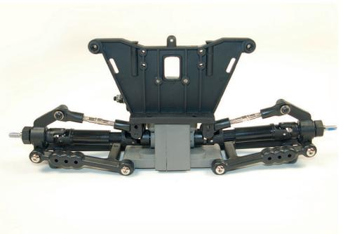
**Die neuen, schmälere Hinterachsteile sind montiert**
