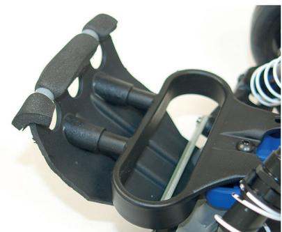
**Der Slash-Bumper wurde zurückgeschnitten und mit Schaumstoff gepolstert**
