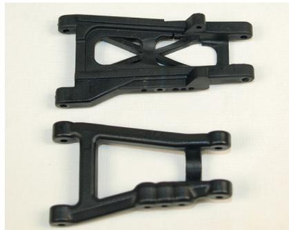
**Vergleich der hinteren Slash-Schwinge und der neuen kürzeren RPM-Schwinge**
