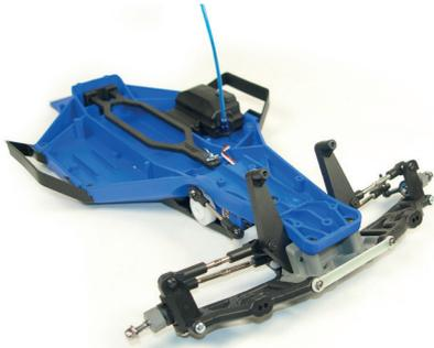
**Die neuen Vorderachsteile sind am LCG-Slash-Chassis montiert**
