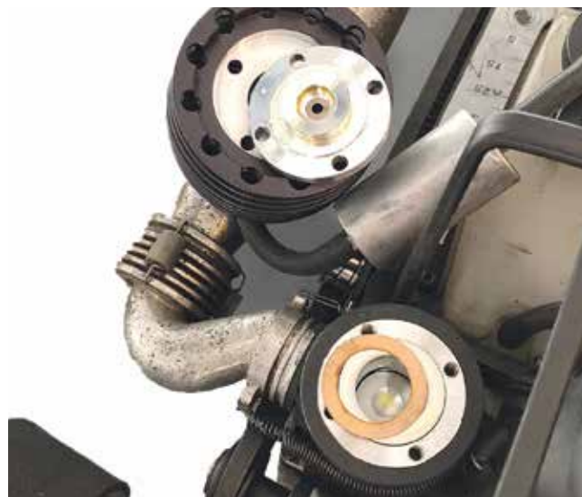
Der Zündzeitpunkt des Motors wird über verschieden dicke Kopfdichtungen eingestellt
