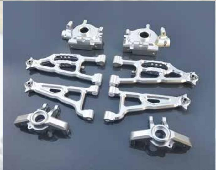
**Aluminium Getriebegehäuse vorne. Getriebegehäuse für einen Kegeltrieb sind in Metall eigentlich immer sinnvoll. Da hier auch die vordere Radaufhängung befestigt wird, verbessert sich die Haltbarkeit der gesamten Vorderachse. Sehr empfehlenswertes Tuningteil mit hohem praktischem Nutzen**
