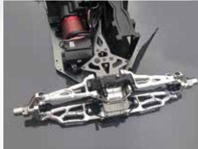
**Aluminium Querlenker haben deutlich weniger Flex in der Vorderachse und mehr Lenkpräzision. Gut für Racing aber auf Dauer kostspielig für Bashing**
