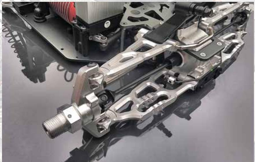
**Für den Super Baja Rey biete Losi nur die Baukastenbereifung an. Wer andere Räder verwenden will, kommt an den Top-Tuning Radmitnehmer mit einem 24mm/6-Kant kaum vorbei**
