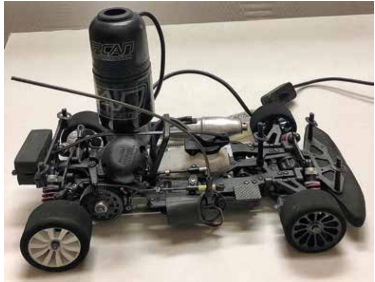
Ein Vorwärmen des Motors schont die Komponenten und hilft beim Kaltstart
