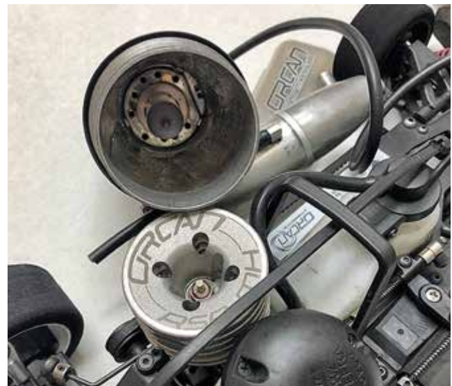
Zum Vorwärmen gibt es verschiedene Systeme, auch ein angepasster Föhn tut hier einen guten Dienst, wenn keine professionellen Geräte verfügbar sind
