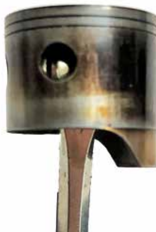
Hier sieht man einen Kolben der genügend Ablagerungen hat, um top Leistung zu haben und belastbar zu sein
